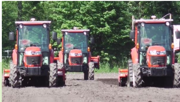
世界初の技術～ロボットトラクタ3台による協調作業
